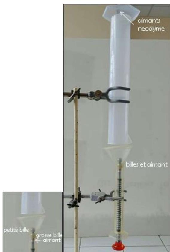
② Nous avons testé le système 2) au laboratoire, c'est le plus facile à utiliser sous microgravité malgré les mouvements parasites ; et grâce au tube, la bille est contenue. Mais cela n'enlève pas les mouvements parasites du montage initial.
